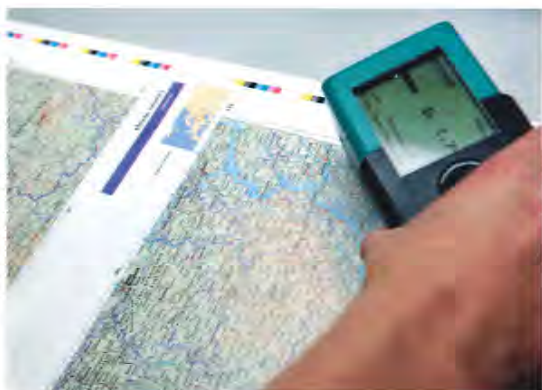
Painaja mittaa arkilta osavärien määrän. Väriä lisätään tai vähennetään tarpeen mukaan.
