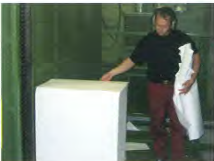
Leikatut arkipinot ajetaan limitettyinä lavalle. Sivutäristimet takaavat, että pinosta tulee siisti ja arkit pinoutuvat tarkalleen toistensa päälle.
