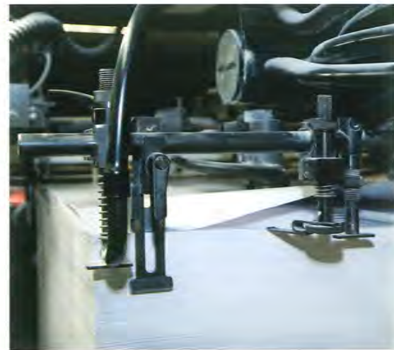
Arkipinon on oltava suora ja arkkien laadutaan virheettömiä, jotta painoprosessi etenee sujuvasti.
