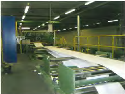
Paperirullien radat kulkevat kohti arkkileikkurin leikkuyksikköä. Radat leikataan ensin leveyssuunnassa ja sen jälkeen pituussuunnassa.
