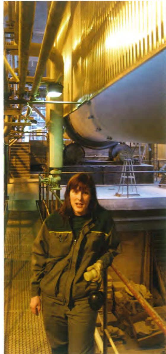
Valkoliipeämö on yksi Kati Tähten työalueista. Sitä hallitsee kuuma ja pitkä meesauuni (yläoikealla).
