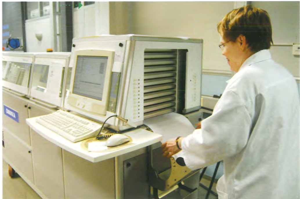
Mirja Tikka syöttää labraan PK 8/C3-linjalta tulleen paperinäytteen linjan omaan näytteenottokoneeseen, Onnikkaan, joka mittaa paperin ominaisuuksia. Koneesta tiedot menevät automaattisesti mittaustulosjärjestelmään, jonka tuloksia seurataan sekä laboratorioissa että valvomoissa.
