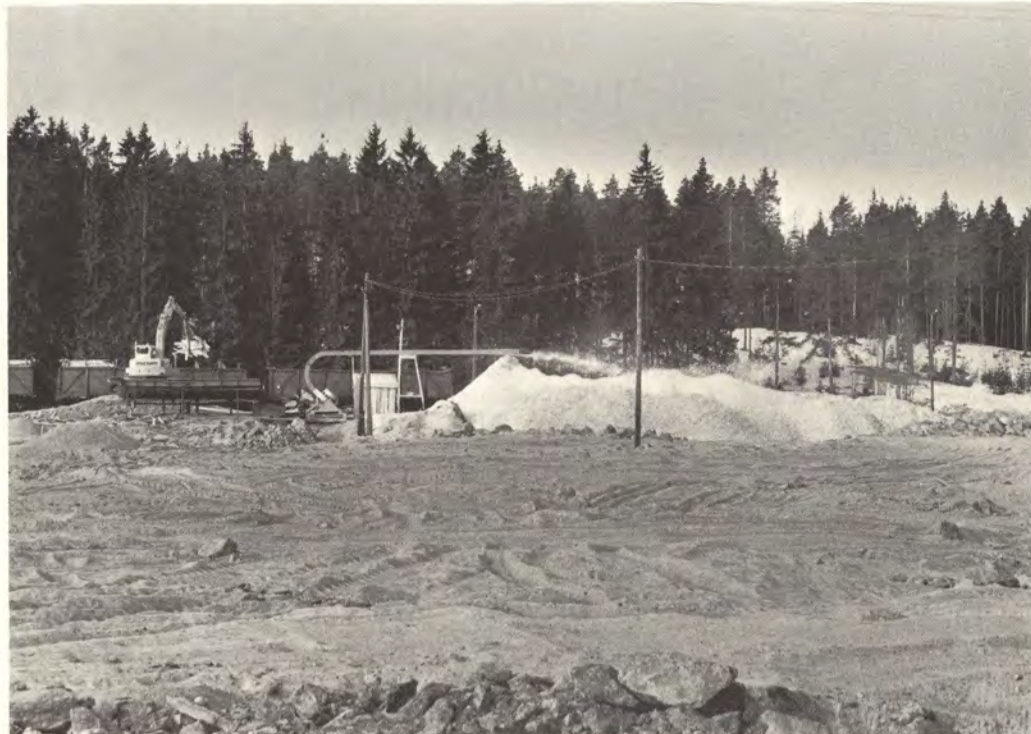
Saksanahon haketusalue Ahlmanintieltä päin kuvattuna. Pääasiassa venäläisten puutavaravau- nujen laitalaudoista saatava hake käytetään sellun valmistuksessa.
