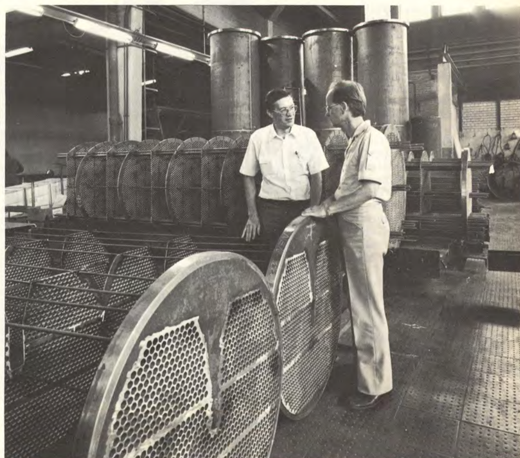
Projektipäällikkö Vesa Jäppinen ja tuoteryhmä 3:n päällikkö Harry Sundberg lämmönsiirrinten kokoonpanohallissa. Etualalla lämmönsiirtimiä, joista puuttuvat vaippa ja sisäputket.
