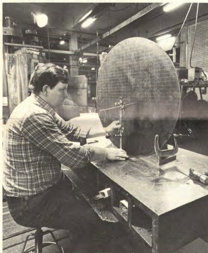
Lämmönsiirtimien päätylevyjen piirrotuksessa määrätään levyihin porattavien reikien paikat. Piirrotustyötä tekemässä Matti Saarenkoski.
