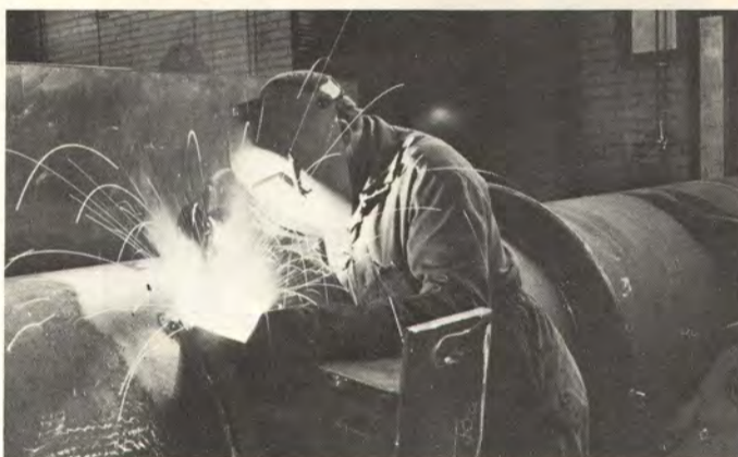
Lämmönsiirtimen valmistus vaatii paljon hitsaustyötä.
