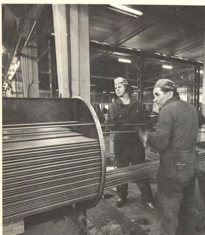
Lämmönsiirrin kootaan työntämällä putket pääty- ja ohjauslevyissä olevien reikien lävitse. Tarkkuutta vaativassa työssä Raimo Partio ja Teuvo Taskinen.
