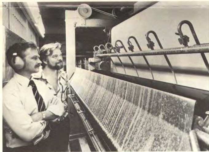
Käyttöinsinööri Aleksander Schoschkoff ja koneenhoitaja Timo Lassila PK 3:n esipäällystysyksikön luona. Esipäällyste valuu oik:lla olevista putkista kahden telan väliseen säiliöön.
