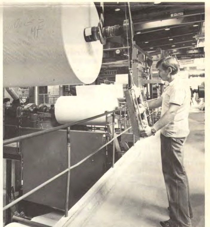
Pituusleikkurin hoitaja Timo Telkinen siirtämässä paperirullaa. Taustalla alla superkalanterit, taaempaan päällystyskone II.
