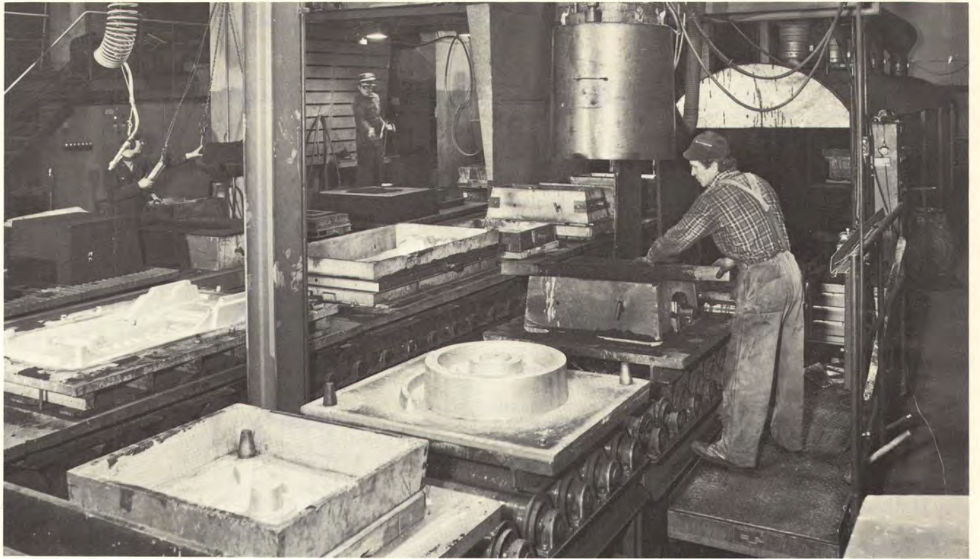
Furaanihartsilinja on Karkkilan valimon uusin tuotantolinja, joka otettiin käyttöön muutama vuosi sitten. Tuotantolinjalla valmistetaan pääasiassa keskiraskaita valukappaleita, painoltaan 50—1200 kg, mm. hammaspyöriä.
