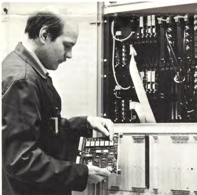
Työnjohtaja Pekka Kettulan kädessä kuva-aseman tiedot sisältävä mikroprosessorikortti; etusormen kohdalla yksi mikroprosessoreista.
