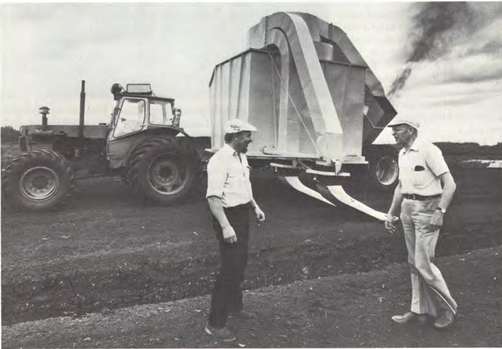
Taisto Raussi ja Haukka suon turvetyömaan tuotantopäällikkö Teuvo Ilmonen etulalla, takana Raussin Metallin valmistama traktorivetoinen imukone HIK-300.
