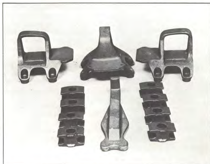
Jousenohjaimet ja nojapalat ovat tyypillisiä Kymeniteen perustuvia raskasta kulutusta kestäviä sarjatuotannossa olevia valukappaleita.
