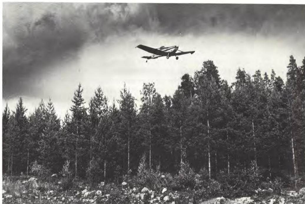
Cessnan siivenkärjet ovat käyrät koneen hidaslento-ominaisuuksien parantamiseksi.
