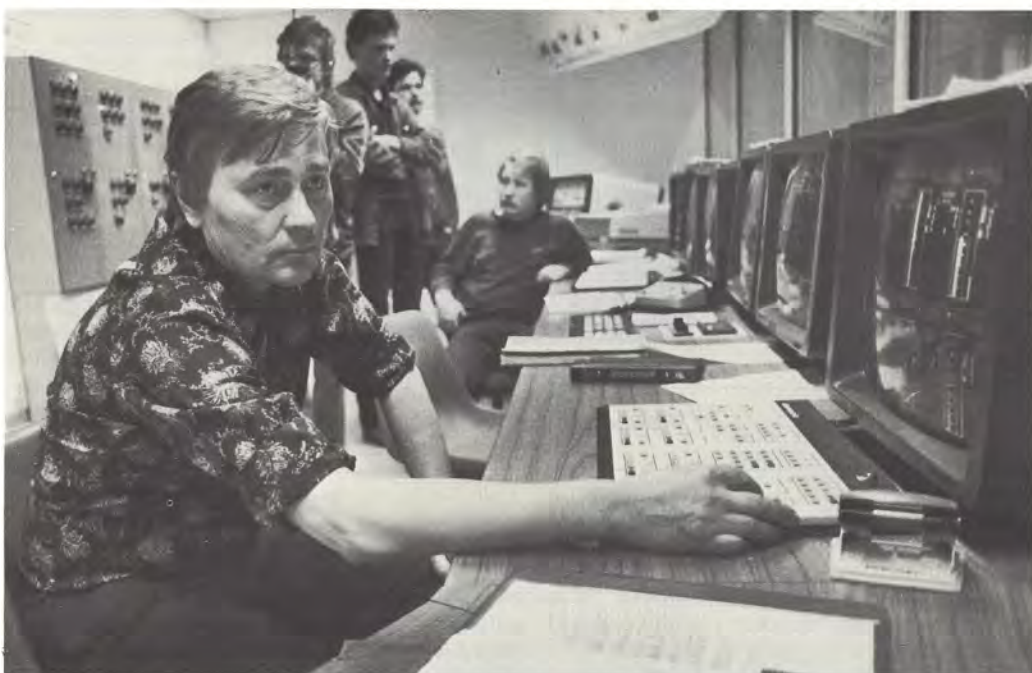
Damaticille on tunnusomaista lukuisien tietojen kerääminen näyttöpäätteille, joita hoidetaan etualalla näkyvän operointinäppäimistön avulla. Työssä koneenhoitaja Vilho Viinikainen.
