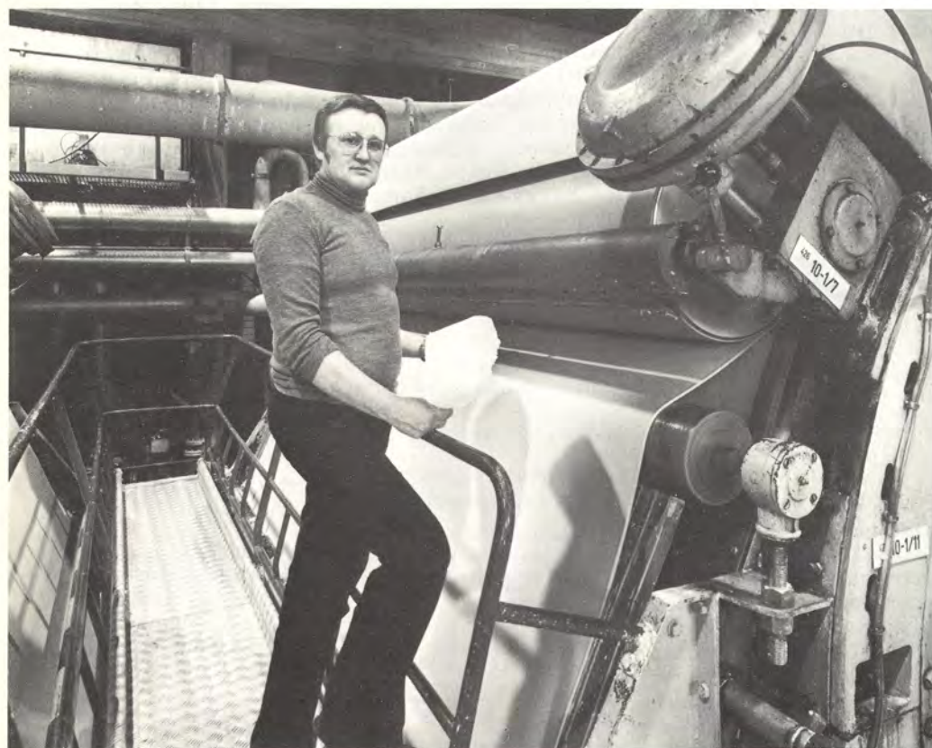
Valkaisija Jorma Laineen on huolehdittava siitä, että hiokeradat pysyvät katkeamattomina saostajilla. Kädessä hänellä on palanen saostajalla ohuena levynä kulkevaa hiokemassaa.
