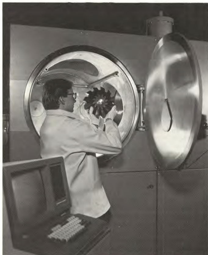
Plasmapinnoittimen prosessitietokoneohjatussa käsittelyssä saavat esimerkiksi lastuavat terät ja muokkaustyökalut kullavärisen, erittäin kovan pinnoitteen, joka pidentää työkalun käyttöä moninkertaiseksi.
