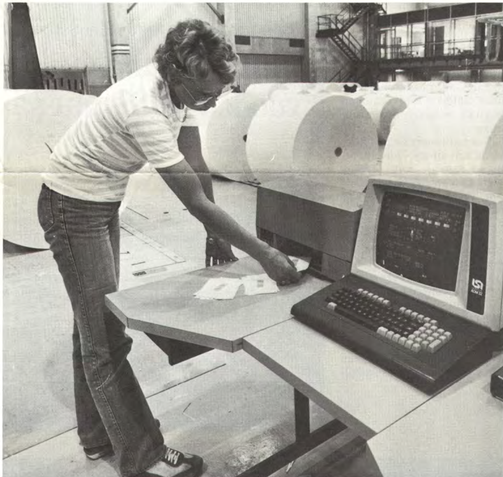
↑ PK 8:n valmistaman paperin jälkikäsitteily alkaa pituusleikkurilta. Kuvassa oikealla oleva näyttöpäätte on pituusleikkurin ajomiehen, kuvassa Tenho Mahasen, tärkeä apuväline.
