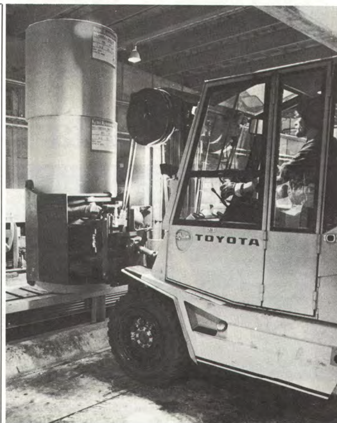
→ Automatiikka muodostaa saman tilauksen rullista 1–4 rullan pinoja trukki-kuljetusta varten.
