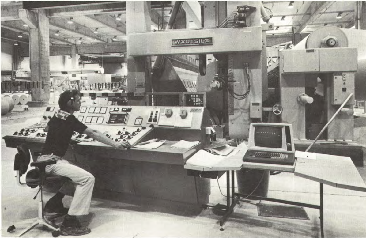
↑ PK 8:n valmistaman paperin jälkikäsitteily alkaa pituusleikkurilta. Kuvassa oikealla oleva näyttöpäätte on pituusleikkurin ajomiehen, kuvassa Tenho Mahasen, tärkeä apuväline.
