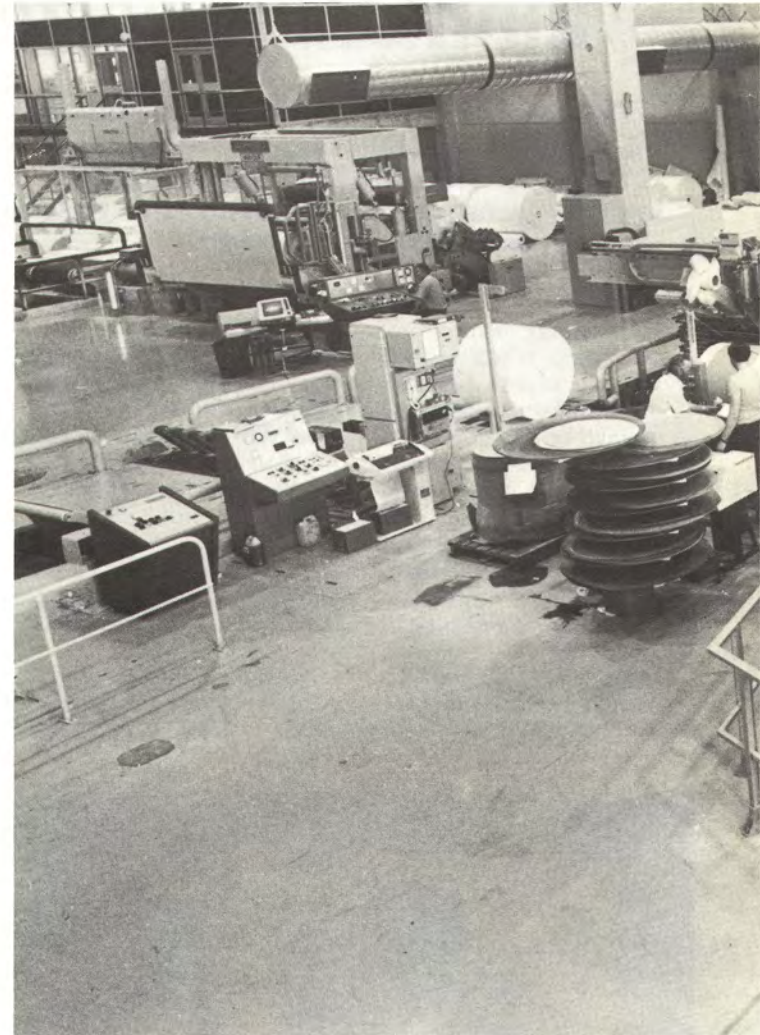
↑ PK 8:n valmistaman paperin jälkikäsitteily alkaa pituusleikkurilta. Kuvassa oikealla oleva näyttöpäätte on pituusleikkurin ajomiehen, kuvassa Tenho Mahasen, tärkeä apuväline.
