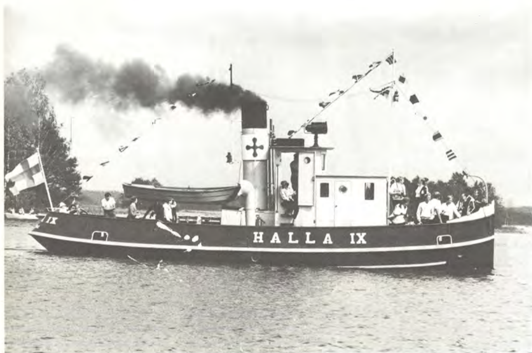
Halla IX on rakennettu Stenberg & Sönerin telakalla Helsingissä v. 1896. Aluksen pituus on 15,6 metriä ja konetehto 100 ind.hv. Laiva toimi pitkään linjahinaajana Saimaalla, kunnes siirtyi loppuvuodensiksi Mäntyharjun reitille.
