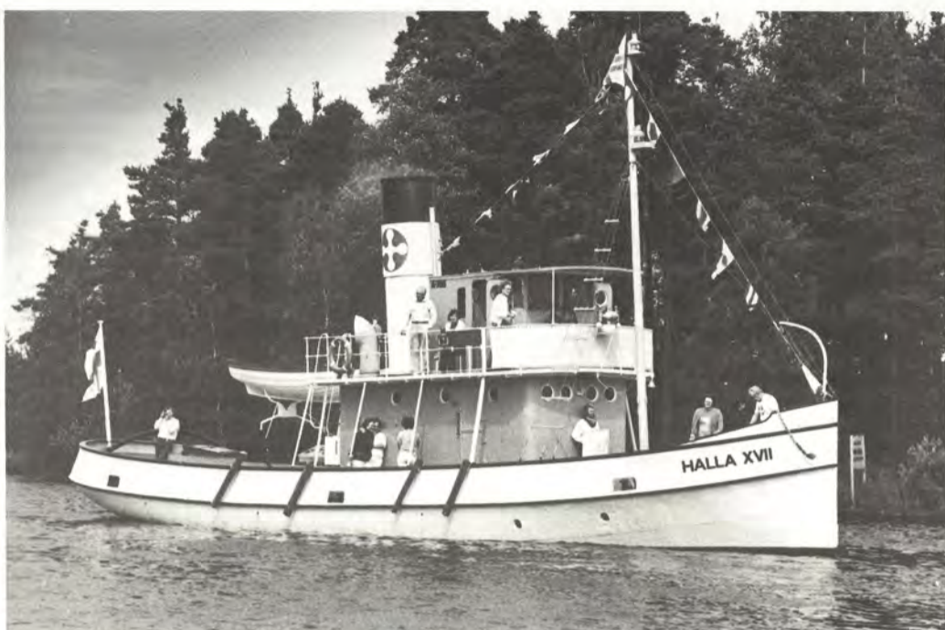
Halla XVII on rakennettu Kotka Järn Aktiebolaginin konepajalla v. 1908. Aluksen pituus on 21,9 metriä ja konetehto 192 ind.hv. Halla XVII toimi Saimaalla sekä Kotkassa. Laivan vakituinen miehistö käsitti yhdeksän henkeä.
