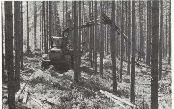
Keskiraskas metsätraktori ja pitkäulotteinen kuormain.
