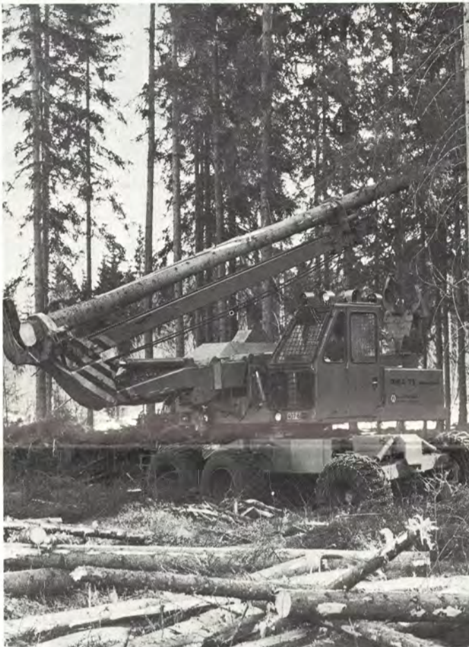
Harvesteri suorittamassa täysin koneellistettua hakkuuta. Kuva 1970-luvun lopulta.
