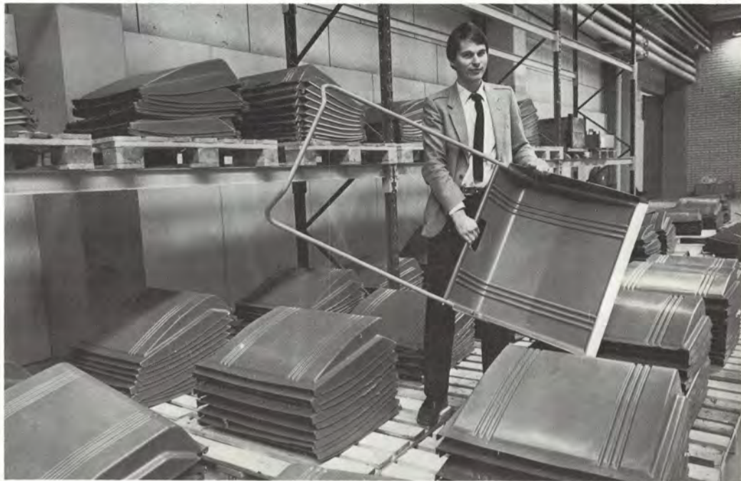
Dipl.ins. Ilkka Kivi kädessään puristamalla valmistettu lumikola. Kolan kärjessä on peltinen vahvike.
