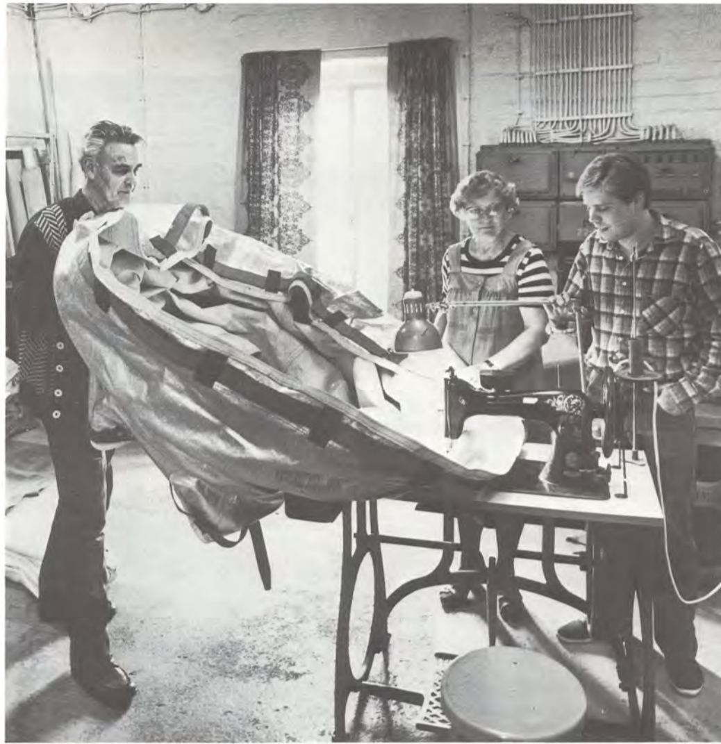
Paperikoneen höyrypoistojärjestelmän liitoskappaleen teossa tarvittiin Jaakko Palmun apuna Maija-Liisa Palmua ja Esa Sormusta.
