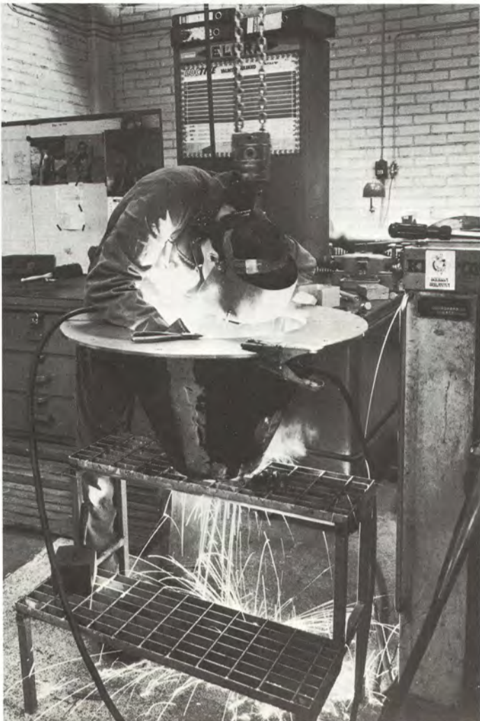
Polttimen osien hitsaus on tarkkuutta vaativaa työtä. Meneillään primääri-ilmakartion valmistus.
