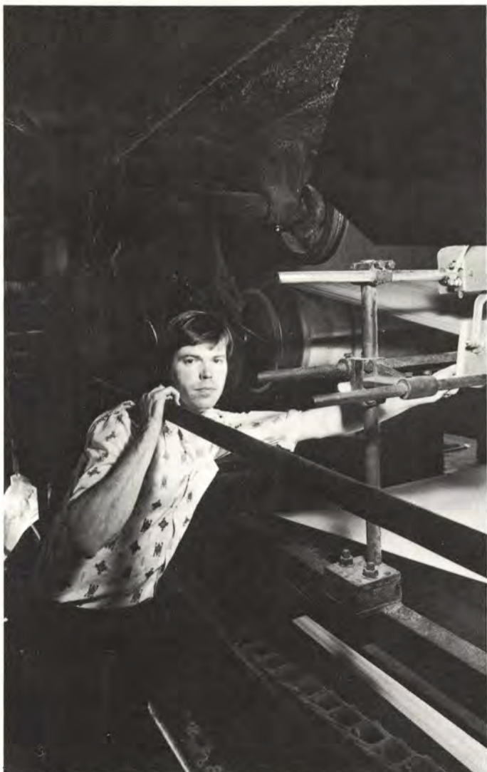
Rullamies tarkastaa myös paperikoneen alla olevat viirojen ohjauksesta huolehtivat automaattit.
