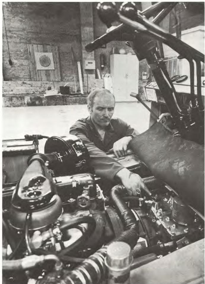
Aaro Jukkara osoittaa trukin vaihdelaatikkaa, jonka kannen sisäpuolelle hän suunnitteli vaihteistoa säästävän laitteen.
