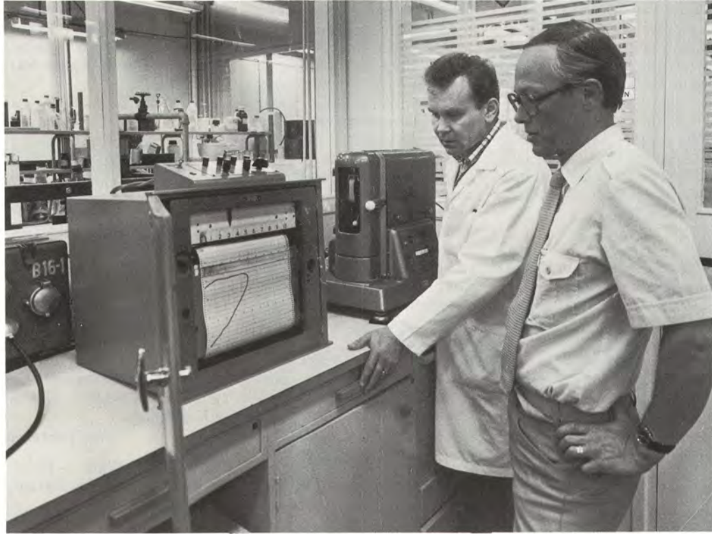
Selluosaston päällikkö Ingmar Lassenius (oik.) ja laborantti Keijo Lehtoranta tutkivat sellu- liuskojen vetolujuutta märkälujuusmittarilla (yllä).
