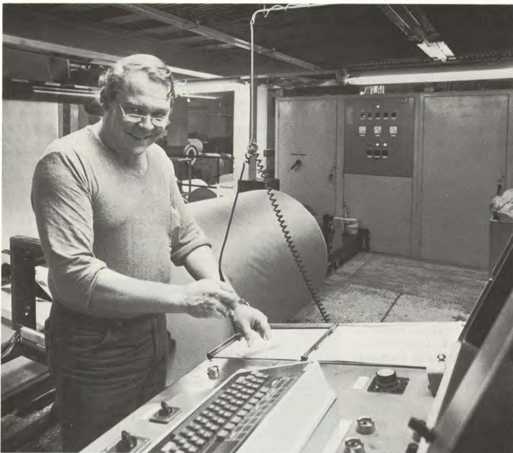
PK 16:n ja 17:n pakkauslinjalla pakataan vuoroa kohti 200—400 paperirullaa. Etumies Kari Hietanen varmistaa, että laatu, määrä ja osoite täsmäävät.
