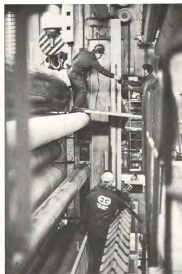
Superkalanterin höyrykytkimiä asennetaan paikalleen (vas.) ja uusintaa viimeistellään (oik.).
