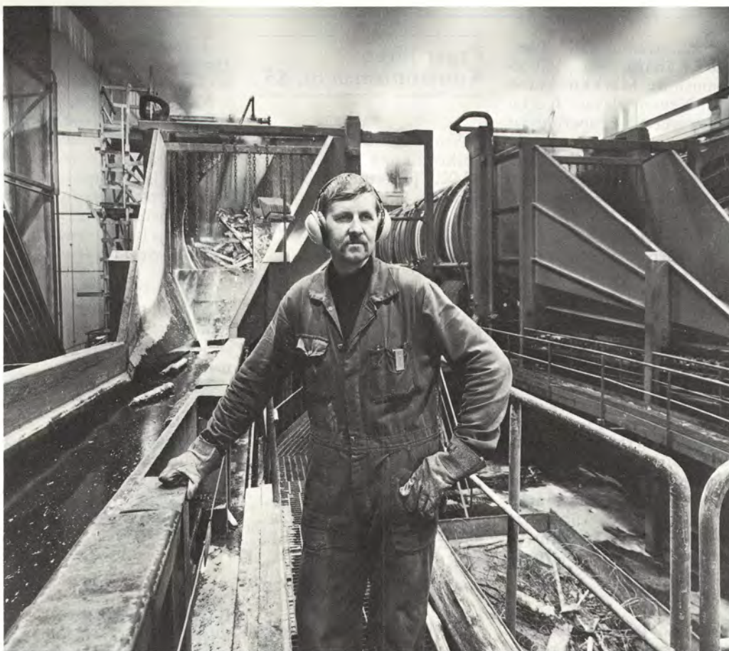
Aarno Halisen työmaa käsittää koko kuorimon alueen. Kuorimon sisällä työ on pääasiassa puu- ja hakeruuhkien purkamisen. Taustalla kuorimarummut.
