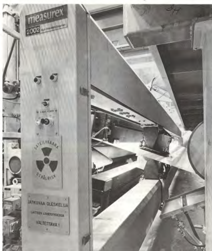
Mittalaitteista tuleva säteily ei ole vaarallista paperikoneella työskenteleville eikä vierailijoille; kilvillä muistutetaan lähinnä käsittelemään säteilylähdettä oikein.
