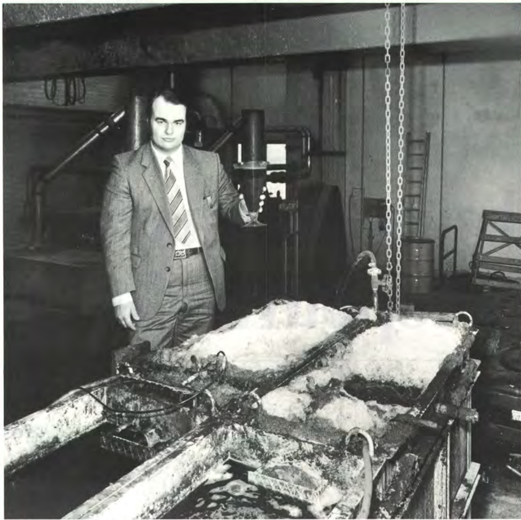
Tehdastutkimusinsinööri Harri Jussila mittaa bakteerimassan määrää ja laskeutuvuutta koe-puhdistamolla.
