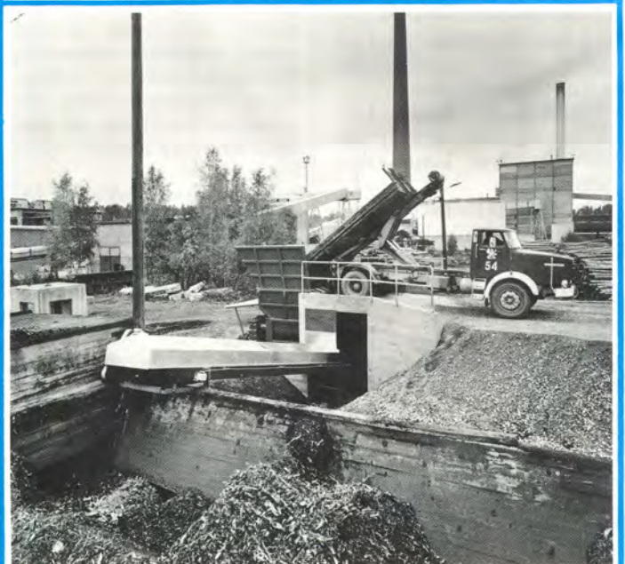
Ruuvimurskaimen ansiosta vuosittain voidaan polttaa noin 2000 tonnia jätettä, joka muuten joutuisi kaatopaikalle.
