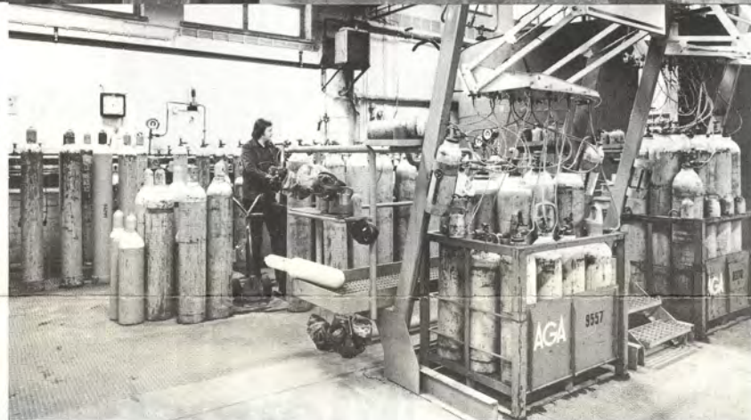
Asetyleenitehtaan hoitaja Kalevi Sonninen ja laitteisto, jossa hienojakoista karbidimurskasta tehtiin asetyleeniä.
