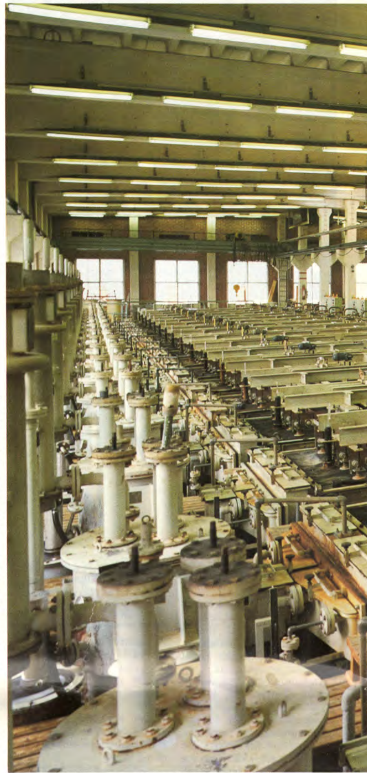
Kemianteollisuuden kloorin ja lipeän tuotantokäy- tehtaan uudempi kennosali. Pienemmässä kuvassa (oik.) tehta-
