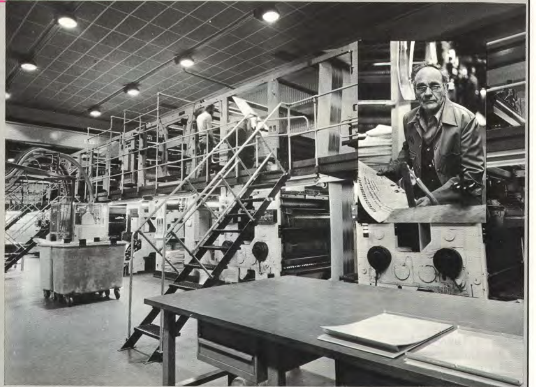
Albert Frankenthal A-500 -offsetrotaatio on kooltaan vain hiukan suurempi kuin Kuusanniemen arkkisalin suurimmat arkkileikkurit. Sillä pystytään tunnissa valmistamaan 35–40 000 lehteä. Painomestari Knut Nyström (pieni kuva) on ollut HBL:n palveluksessa 38 vuotta.
