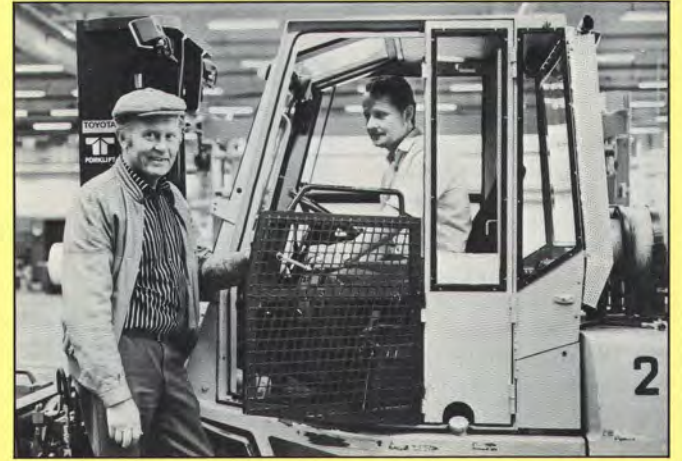
Trukinkuljettaja Ossi Rämä (oik:lla) kertoo työovereidensa poikkeuksetta olleen tyytyväisiä Matti Rämän ideoimaan kesäoveen. Kuvan trukissa on uudentyyppinen ovi.
