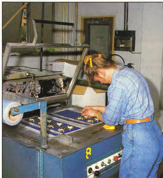
Osaan valmistamistaan pakkauksista Greenups sijoittaa myös sisällön. Tällä koneella saavat verhonpidikkeet ympärilleen muovin ja alleen kartongin.
