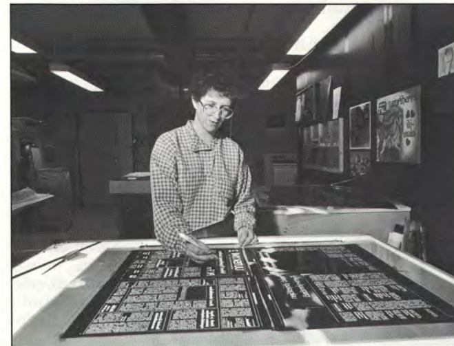
Asemointi tehdään valopöydällä. Kalvot ja maskit pyydyvät tarkasti paikallaan maskin alareunassa olevien nastojen avulla.
