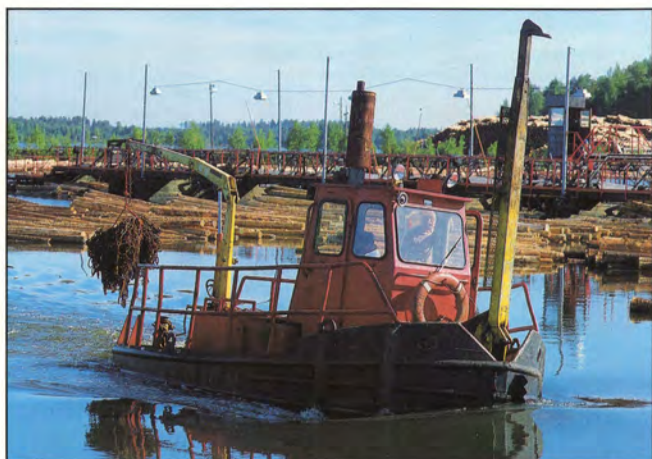
Tehdasvarastossa työskentelee 3 hinaajaa ja 4 hinausmoottoria. Nippulauttojen purkutyössä käytetään kahta log sorter -tyyppistä 'vesitraktoria', Pinusta ja Betulaa, joista jälkimmäinen kuvassa.
