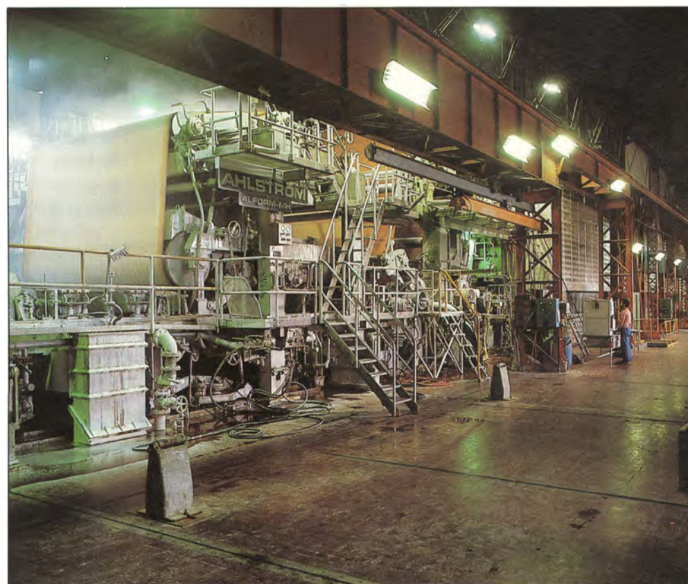
Boucher'n paperikone on Voith-Dörries vuodelta 1975. Koneen leveys on 3,8 metriä ja kapasiteetti viimeisimmän uusinnan jälkeen 75 000 tonnia. Sellun kone saa pääosin Suomesta.
