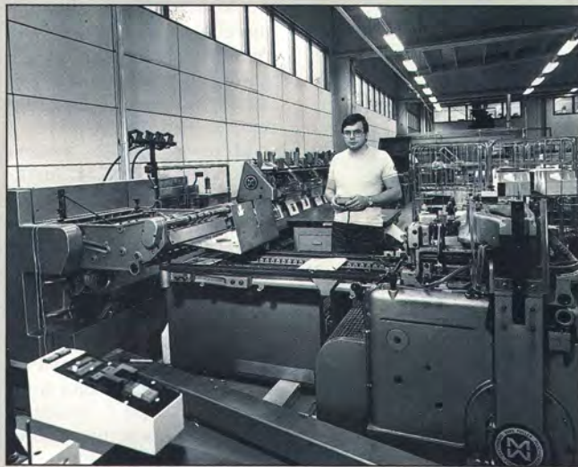
Lehti kootaan lopulliseen muotoonsa ketjustiftauskoneessa. Kuvassa sitomokonetyöntekijä Rauno Karjanmaa valvomassa arkkien stiftausta.
