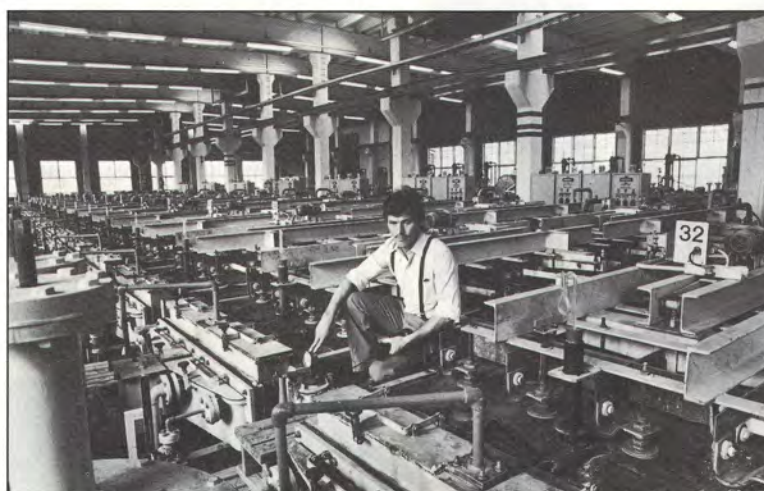
Kennoissa kiertävästä suolaliuoksesta purkautuu sähkön avulla kloorikaasua. Prosessinvalvoja Kalevi Pahkalan tehtäviin kuuluu kiertää kennosalissa ja tarkkailla, että kaikki on kunnossa.
