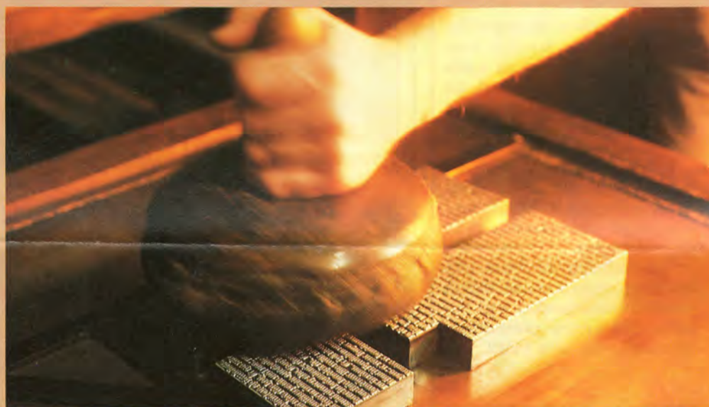
Painomuste levitettiin koirannahasta tehdyllä tyynyllä.
