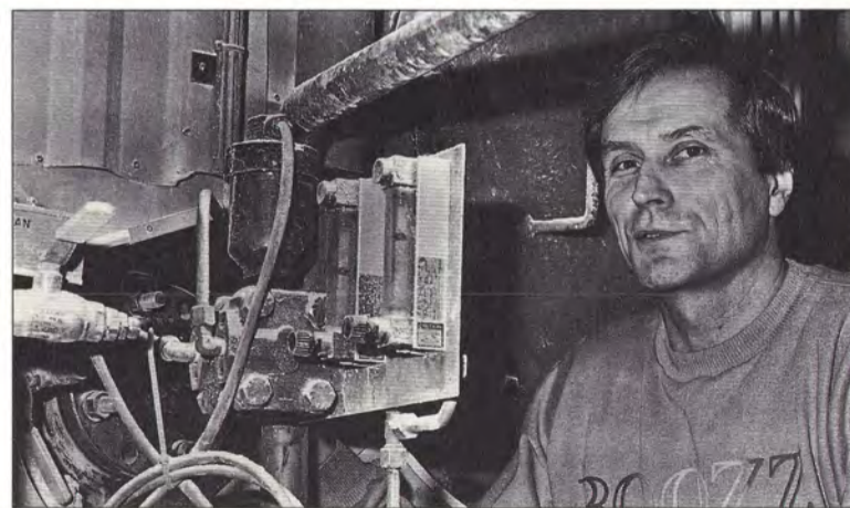
Seppo Rainio keksi sammutusastian pintamittausyhteen venttiilikonstruktion, jolla laite voidaan puhdistaa astian ulkopuolelta.
