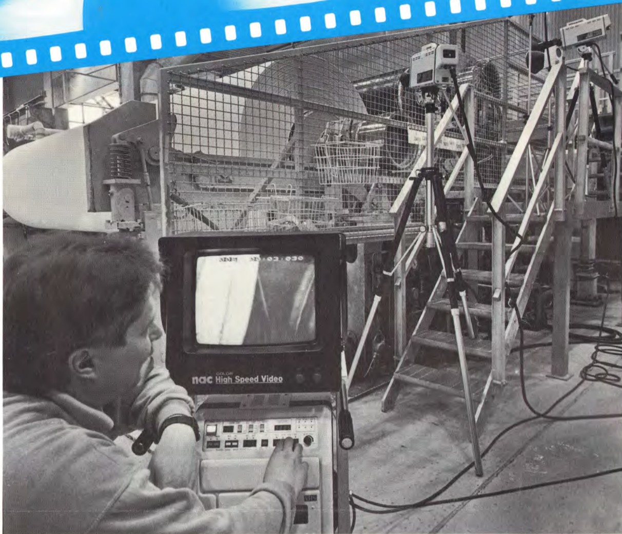
High speed -video toiminnassa. Yllä olevissa pienissä kuvissa näkyy rullanvaihto päällystyslaitoksella. Ensimmäisen ja viimeisen kuvan välillä on kulunut 80 tuhannesosasekuntia.
