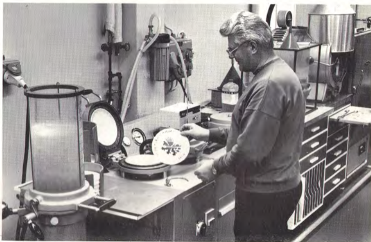
Selluarkin valmistus meneillään: Rauno Ärling panee teflonista leikatun muotin selluarkin päälle kuivaimeen. Vasemmalla arkkimuotti.
