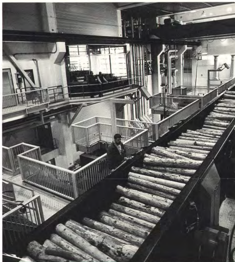
Uuden painehiomon kuuden hiomakoneen tuotantokapasiteetti on 170 000 tonnia hioketta vuodessa.
