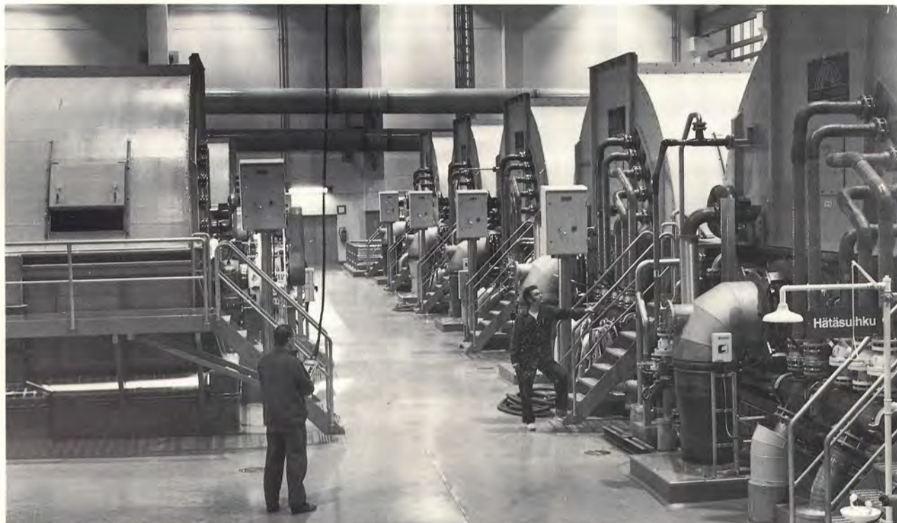
Uusi valkaisulinja on vähentänyt jätevesien orgaanisten klooriyhdisteiden määrää.
