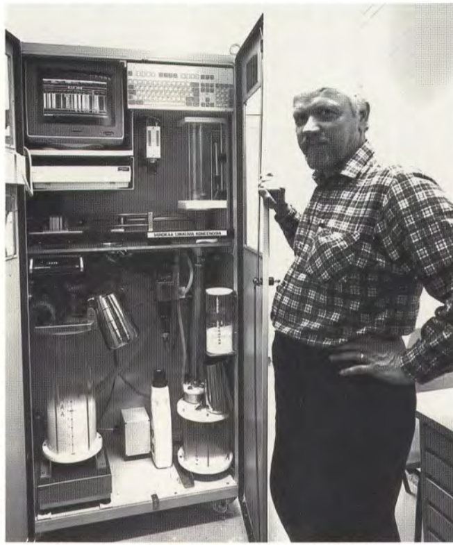
Selluanalyysaattori ottaa näytteet kuitulinjoilta sekä paperitehtaalle ja kuivatuskoneelle menevistä massoista ja analysoi ne automaattisesti. Mittauspisteitä on yhteensä kahdeksan. Oikealla laboratoriotyöntekijä Seppo Munne.
