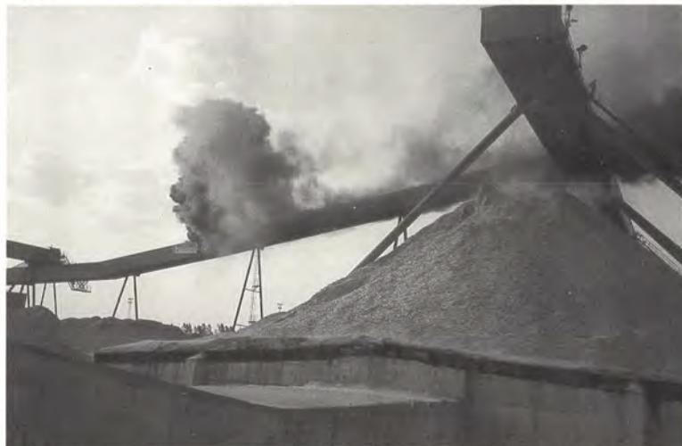
... katkennut kuljetinhihna levitti palon kuljetinsillan rakenteisiin ja hihnan liikkeen vaikutuksesta irtoavaan pölyyn ...
