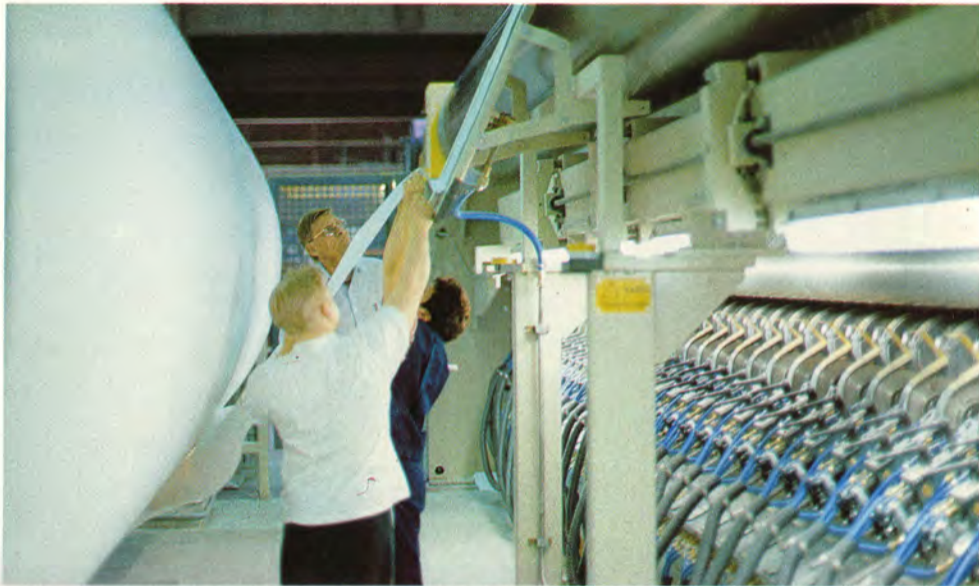
Tampuurin vaihto ja päänvienti käynnissä uudella pituusleikkurilla. Työssä pituusleikkurin apulainen Kimmo Karjalainen , käyttöönottoinsinööri Ilkka Saarela Valmetilta ja pituusleikkurin apulainen Vappu Brofeldt .
