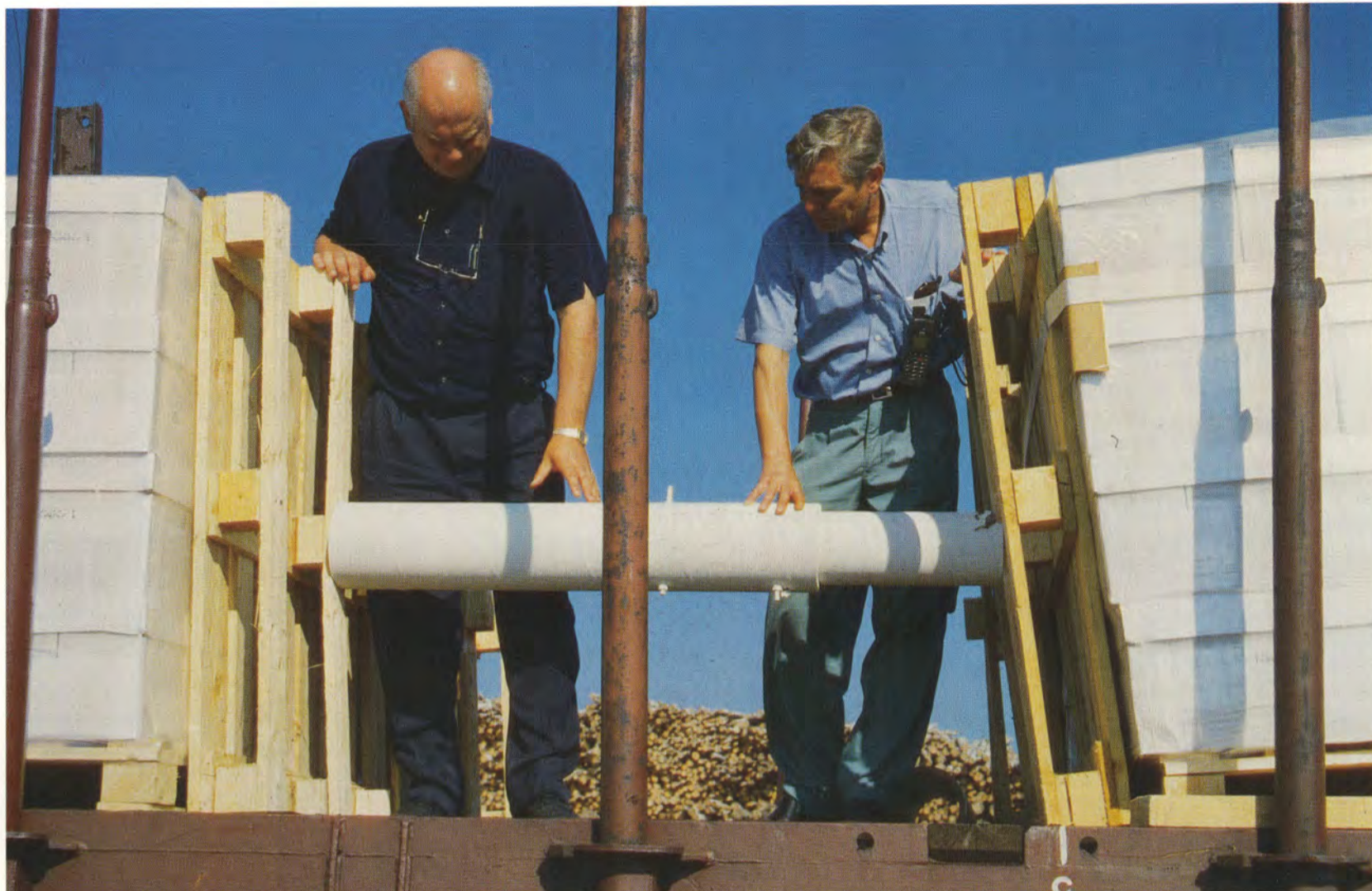
15 km:n tuntinopeus törmäyshetkellä aiheutti jo tukien vääntymistä – palleit eivät kuitenkaan vielä tässäkin vaiheessa rikkoutuneet, vaikka liikahtivat voimakkaasti. Pentti Eskelinen (vas.) ja Harri Heijala tutkivat törmäysvahinkoja.
