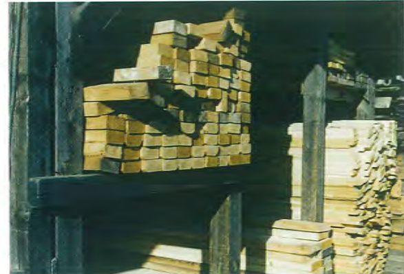
Kuvassa rakennusosaston puutavaravars- ton vakkeja eli puukehikoita, joihin puuniput nostetaan.
