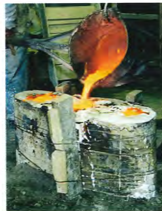
Valmistusprosessin kriittisin vaihe on sulan pronssin kaataminen lopulliseen muottiinsa.
