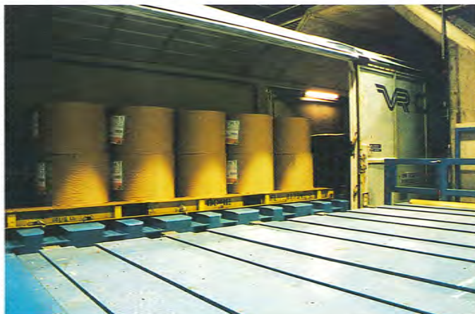
Rautatievaunun lastauksessa käytetyn irtoalustan koekäyttö onnistui paperivarastossa ja satamassa hyvin.
