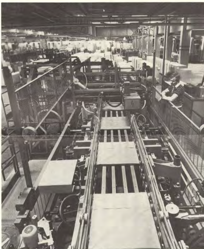
10—15 kappaleen minuuttivauhdilla valmistuu arkkipaketteja Kymin paperitehtaan arkkisalissa uudella käärimiskoneella. Pakettien suojana käytetään polyeteenimuovilla päällystettyä käärepaperia. Kuvassa oikealla käärimiskoneen hoitaja Raimo Timonen.
