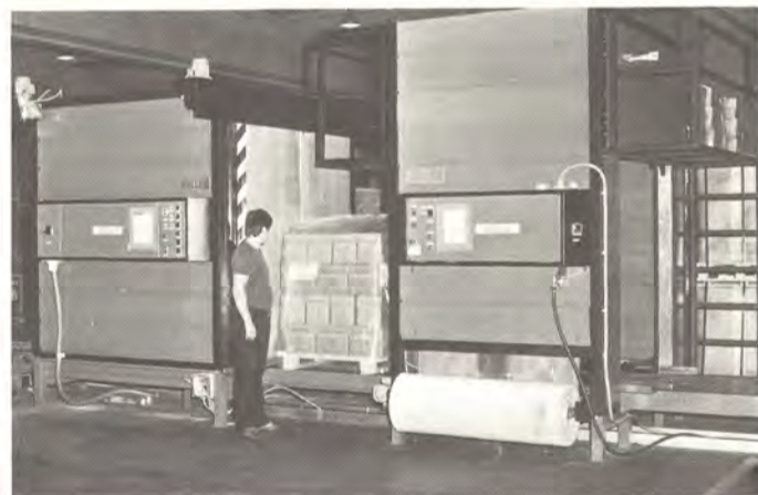
Kutistepakkauslinja muodostuu kahdesta yksiköstä: oikealla olevasta huputtajasta ja vasemmalla olevasta kuumentajasta.
