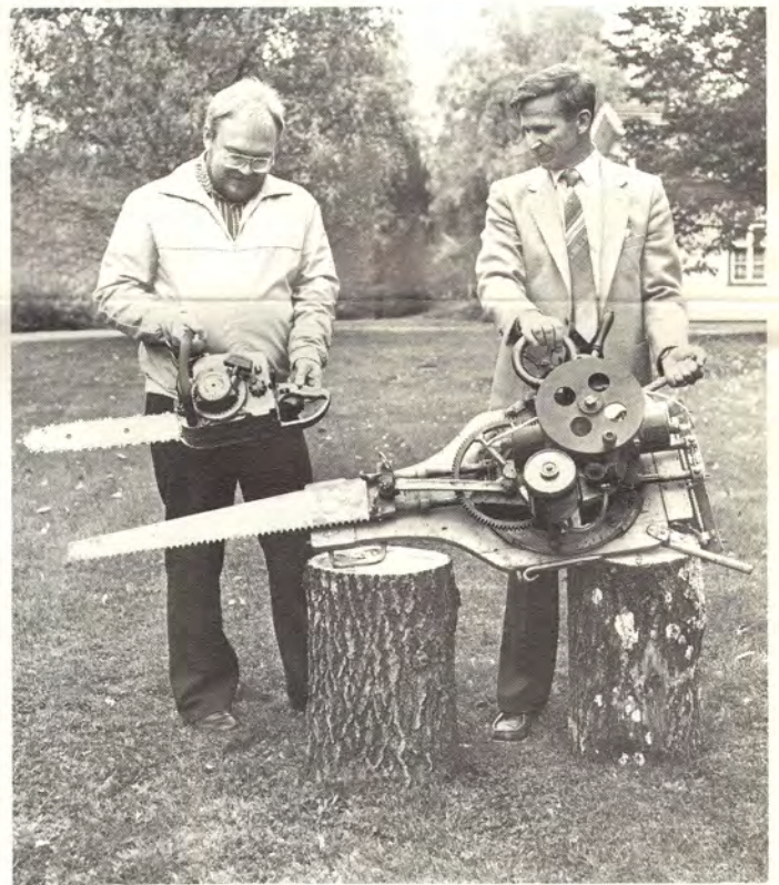
Tehdaspuun operaatiopäällikkö Kari Laitinen (oik.) ja metsänhoitaja Väinö Hirvonen operaatio-osastolta esittelevät moottorisahojia, joilla on ikäeroa 60 vuotta. Molempien teho on jokseenkin sama, mutta pienempi painaa 6 kiloa ja suurempi n. 80 kiloa. Vanha Arbor antoi työnäytöksen viimeksi v. 1976, jolloin kuningatar Elisabeth oli Tehdaspuun vieraana Keski-Suomessa.
